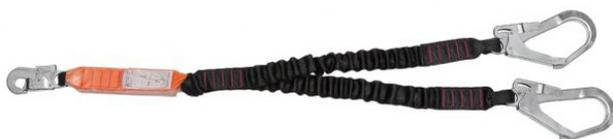
Talabarte Y tubular com absorvedor de energia e conectores classe A (abertura de 55mm) e classe T (abertura de 18mm).
