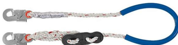
Talabarte de posicionamento em corda torcida fixa aos conectores através de entrelaçamento com regulador em polímero e conectores classe T (abertura de 18mm).
