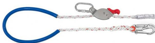
Talabarte de posicionamento em corda torcida fixa aos conectores através de entrelaçamento com regulador de distância em aço inox e conector classe T (gancho de 18mm).
