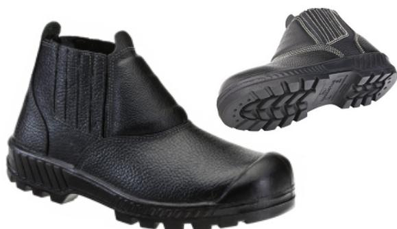
Bota de segurança em couro vaqueta, fechamento em elástico, forração em tecido kevlar, palmilha de montagem em kevlar, solado em PU/Borracha com sistema de absorção de impacto, injetado diretamente ao cabedal.
