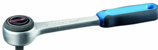
Aço Gedore-Vanadium. Niquelado e Cromado. Para trabalhar com acessórios manuais com encaixe a 6,35 mm (1/4"), conforme DIN 3120-C 6.3, ISO 1174, com sistema de retenção por esferas. Indicado para parafusos perfil torx. Modelo curto.
