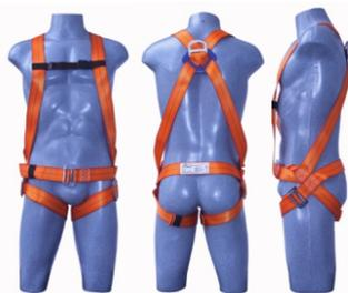
Sinto de Segurança tipo paraquedista com 1 (um) ponto de ancoragem. Detalhes: fitas em poliéster, ponto dorsal, fivela de engate rápido. Setor industrial e construção civil.
