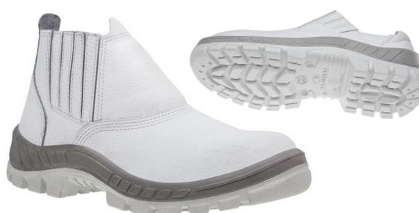
Bota de segurança em couro vaqueta, fechamento em elástico, forração, palmilha de montagem em poliéster resinado fixada junto ao cabedal, solado em PU Bidencidade bicolor com sistema de absorção de impacto, injetado diretamente ao cabedal.
