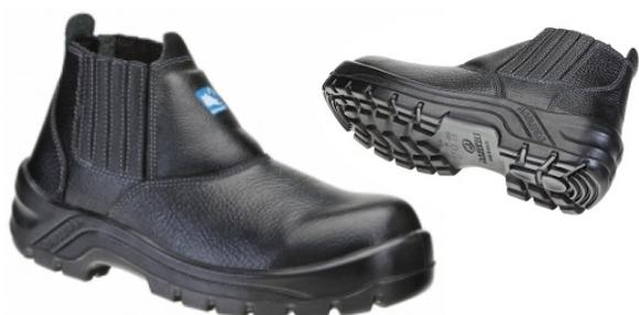
Bota de segurança em couro vaqueta, fechamento em elástico, forração, palmilha de montagem em tanino dublada ou têxtil resistente a perfuração, biqueira de composite, solado em PU Bidencidade bicolor com sistema de absorção de impacto, injetado diretamente ao cabedal.
