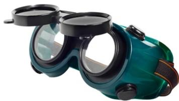
Óculos de segurança, constituídos de armação confeccionada em uma única peça injetada de PVC verde, dotada de 4(quatro) válvulas para ventilação indireta e aberturas para o encaixe de duas oculares redondas. As oculares possuem soquetes rosqueáveis, os quais permitem a fixação de filtros de luz na tonalidade 6. A armação cobre toda a região em torno dos olhos e é ajustada ao rosto do usuário por meio de um tirante elástico.
