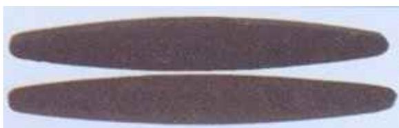
Utilizada para afiação de todos os tipos de ferramentas de corte.
