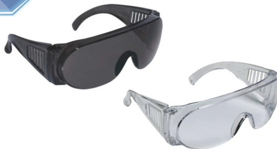
Óculos de segurança com armação e visor confeccionado em uma única peça de policarbonato. Hastes do tipo espátula, com 6 fendas para ventilação. Também em policarbonato, as lentes oferecem uma proteção visual multidirecional. Proteção contra raios UVA e UVB.
