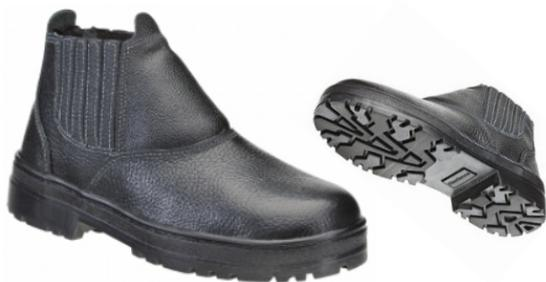
Bota de segurança em couro vaqueta, fechamento em elástico, forração, palmilha de montagem em poliéster, solado em PU/Borracha Nitrilica com sistema de absorção de impacto, colado e costurado ao cabedal.
