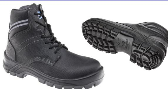
Bota de segurança em couro vaqueta, fechamento em cadarço, colarinho em sintético soft acolchoado forrado em tecido não tecido respirável, palmilha de montagem têxtil resistente a perfuração fixada/costurada junto ao cabedal, biqueira de composite, solado em PU/Borracha com sistema de absorção de impacto, injetado diretamente ao cabedal.
