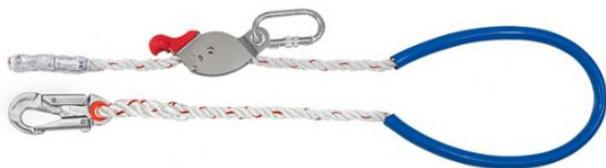
Talabarte de posicionamento em corda trançada fixa aos conectores através de costura dupla reforçada com regulador de distância em aço inox e conector classe T (gancho de 20mm).
